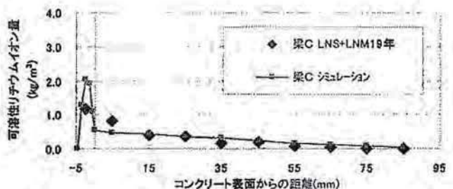
図 15 梁Cの曝露 19 年目の実測値とシミュレーション値
