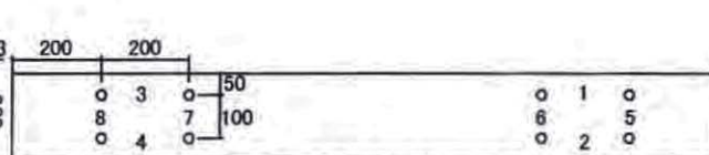
図-3 プラグ取り付け位置 (mm)
