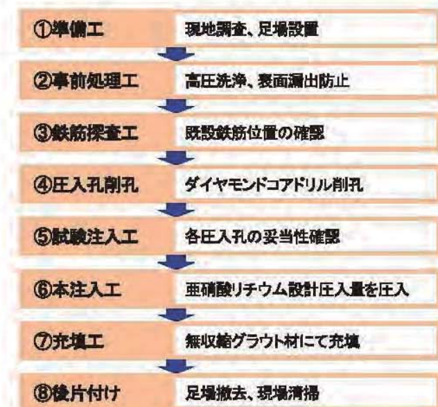
図-3 施工フローチャート
