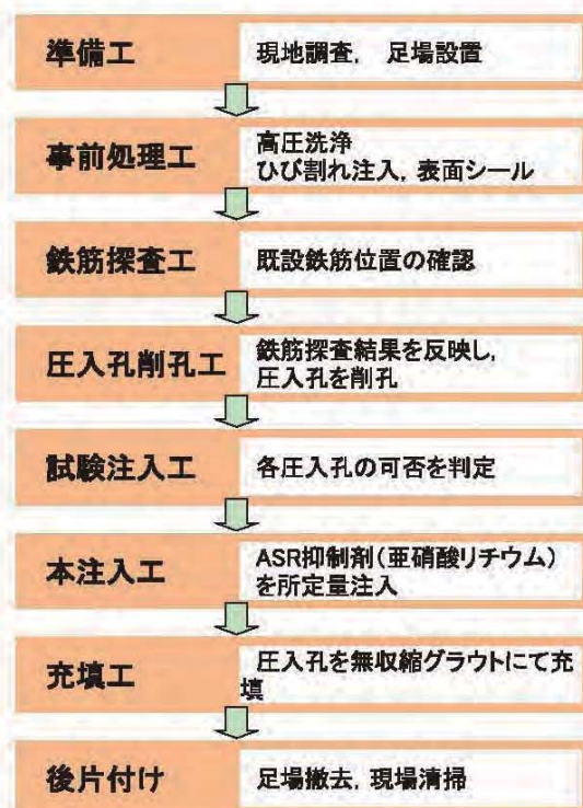
図-2 施工フロー
